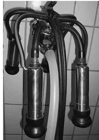
კლასტერი მუდამ უნდა შემოწმდეს დაზიანებებზე
